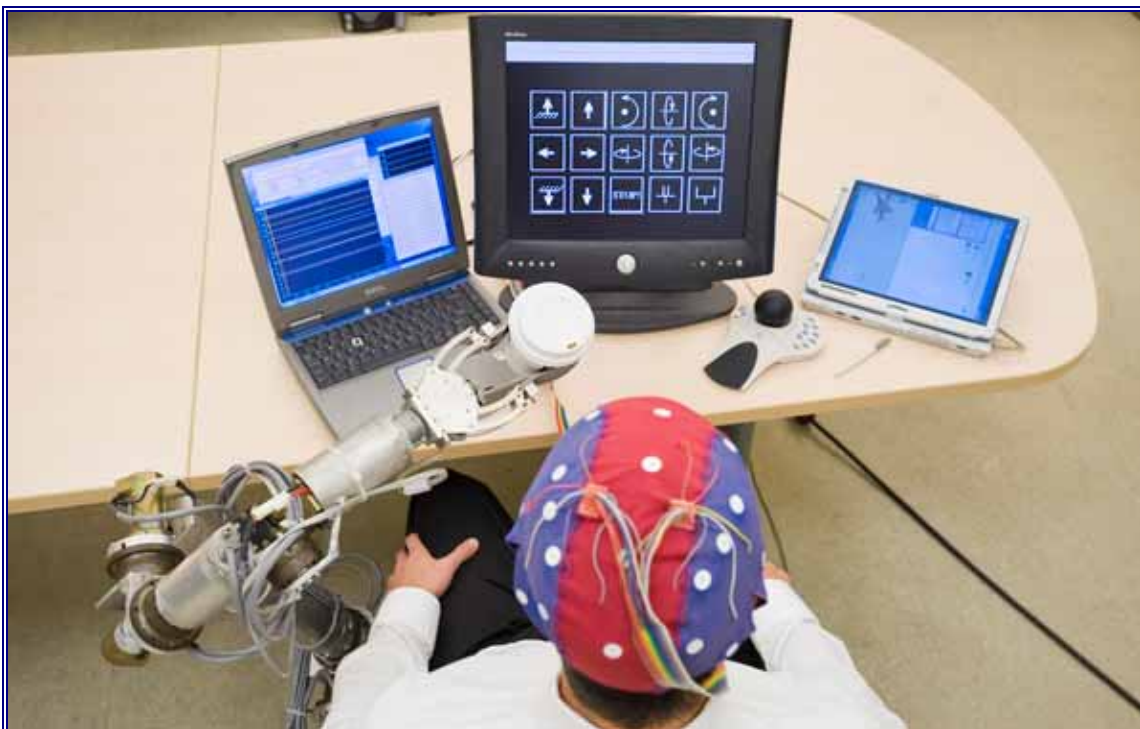
Рис.5. Управление роботом (протезами) при помощи интерфейса «человек-компьютер» [P3].
